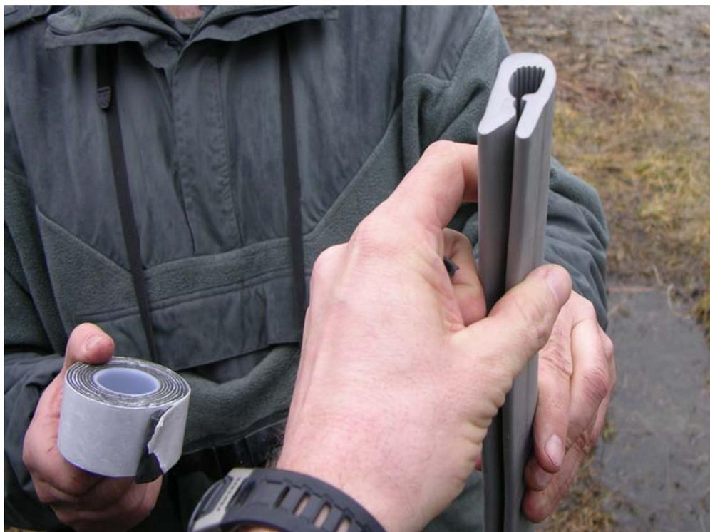
**Figura 4:** nastro autoagglomerante e profilo in gomma per l'isolamento dei sostegni (Sondrio, 2011).
